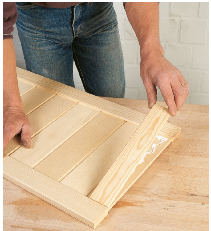
Möbelzuschneidetüren: Anleimen der Rahmenabschlussleiste
